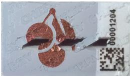
Am Slotsiegel kann eine Manipulation erkannt werden. In diesem Fall ist der Betrieb des Kartenterminals nicht mehr sicher.
